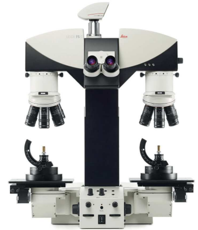
Macroscopie de comparaison, permettant d'observer simultanément deux échantillons en superposant les images ou en les fractionnant. Cela permet notamment de vérifier la continuité des stries sur deux portions de projectiles.
