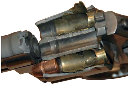
En cas d'accident lié à l'explosion d'une arme, l'expert doit rechercher les causes : mauvaise utilisation du tireur, défaut de conception ou de fabrication, etc.
